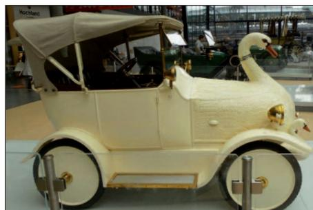
Der „Baby-Schwan“ wurde aus Stahlblech von Hand geschlagen und ist mit einem Elektromotor ausgestattet
